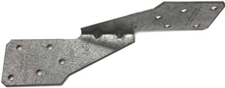
Figure 19 : Les attaches, agrafes ou sangles antiouragan sont des bandes métalliques conçues pour relier les chevrons ou les fermes de toit aux poutres sablières des murs. (Source : IPSC)
