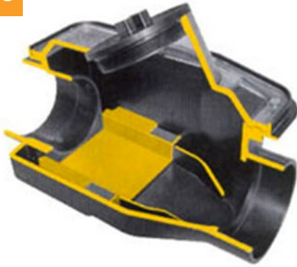
Clapet antiretour normalement ouvert
